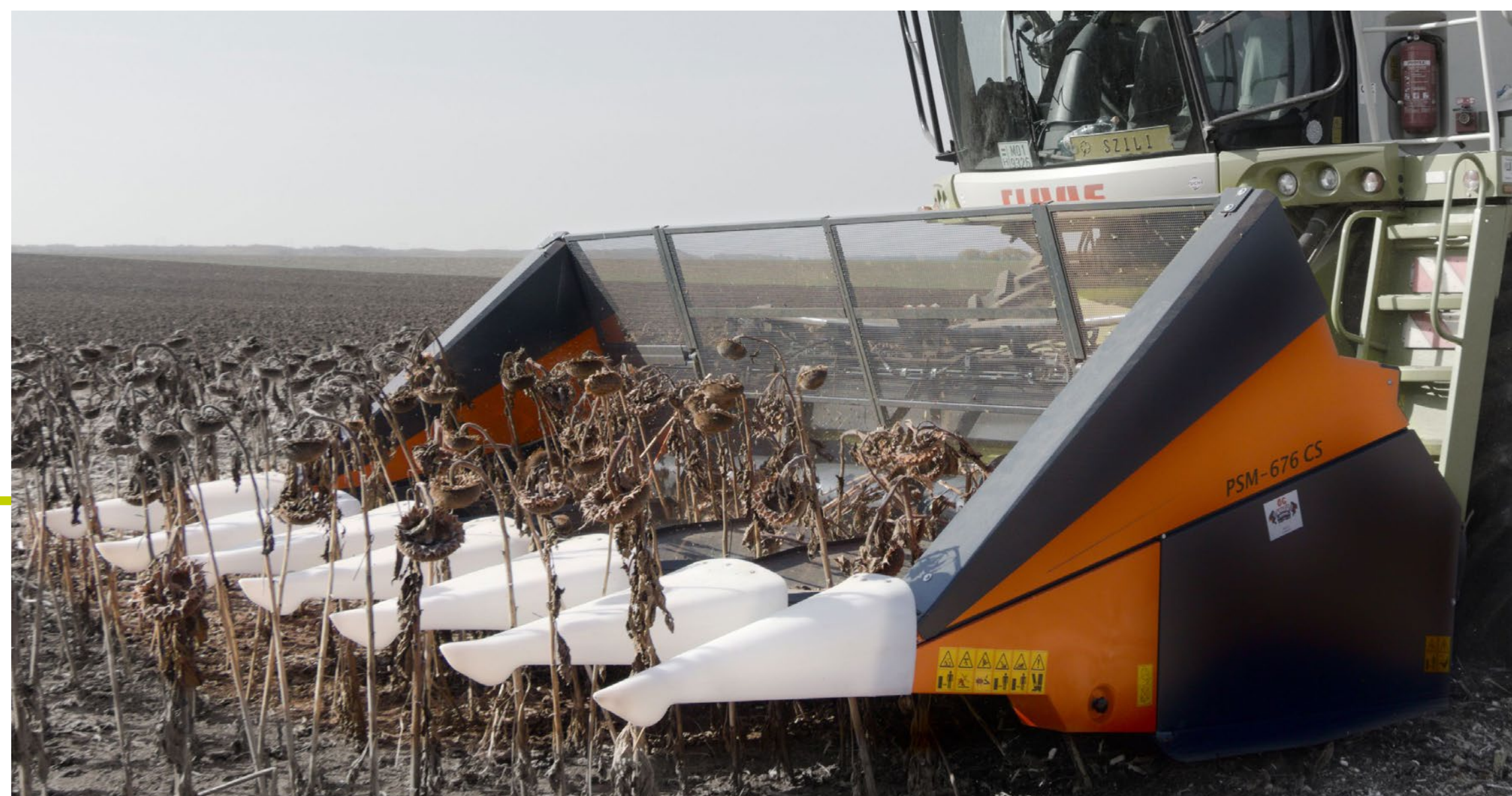
Napraforgó-betakarítás és szárzúzás 6 soros, összecukható adapterrel
